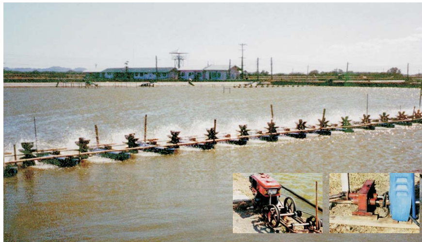
Gbr. 10. Kincir berangkai. Gambar pada insert adalah mesin diesel (8hp) dan motor listrik (1 hp) Yang tersambung ke suatu penahan kecepatan yang dirancang untuk mengoperasikan kincir berangkai tersebut dengan sejumlah 10 - 15 kipas.
