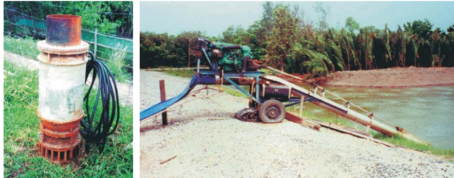
Gbr. 13. Pompa listrik listrik dan yang bertenaga disel.
